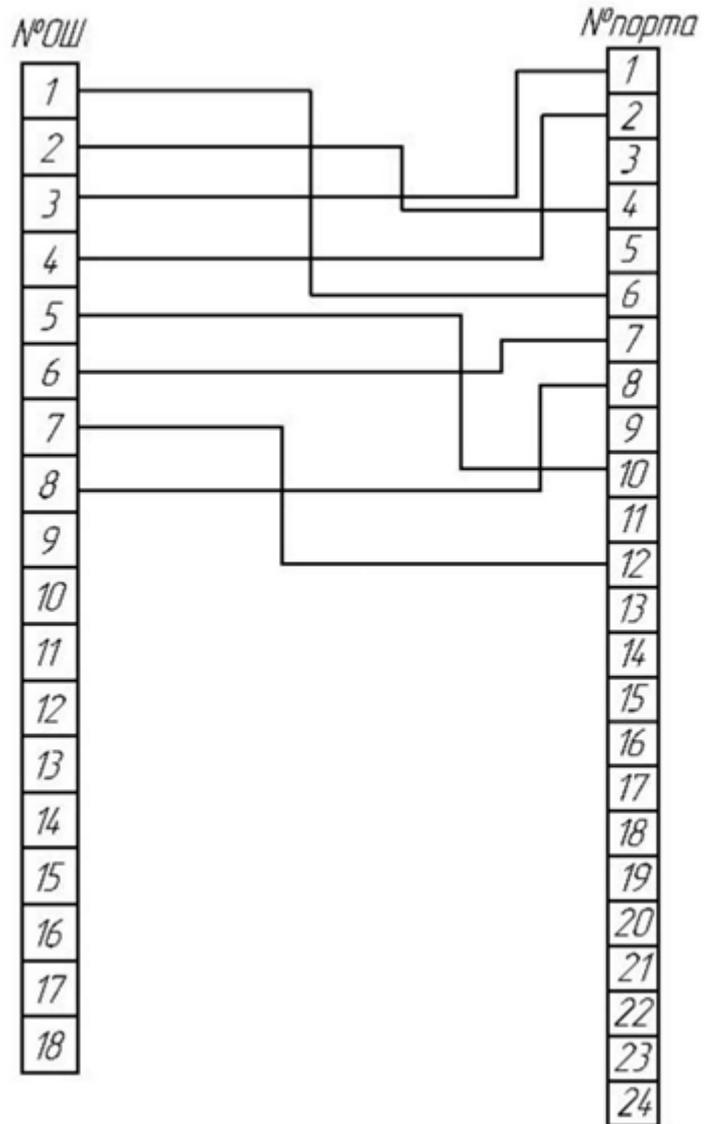
Схема соединения оптических волокон в кроссе
