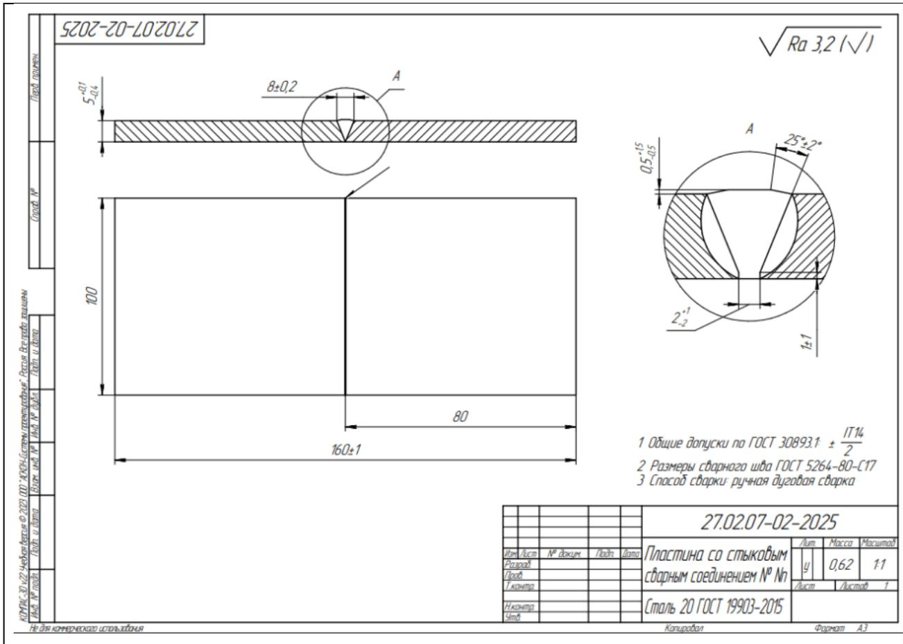
Рисунок 1 – Чертеж пластины
