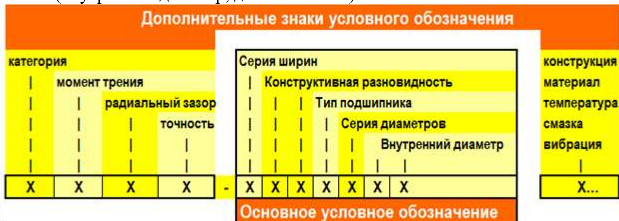
Рис.6.12. Структура обозначения подшипников качения
