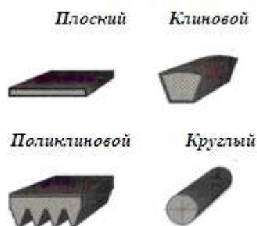
Рис.2.6. Формы профиля сечения ремней
