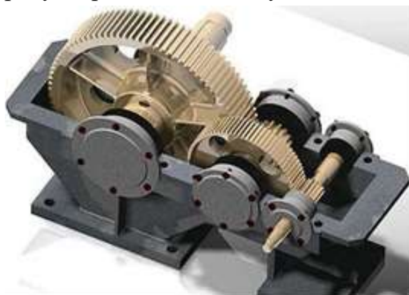
Рис.2.10. Двухступенчатый цилиндрический редуктор
