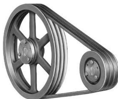
Рис.2.4. Общий вид клиноременной передачи
