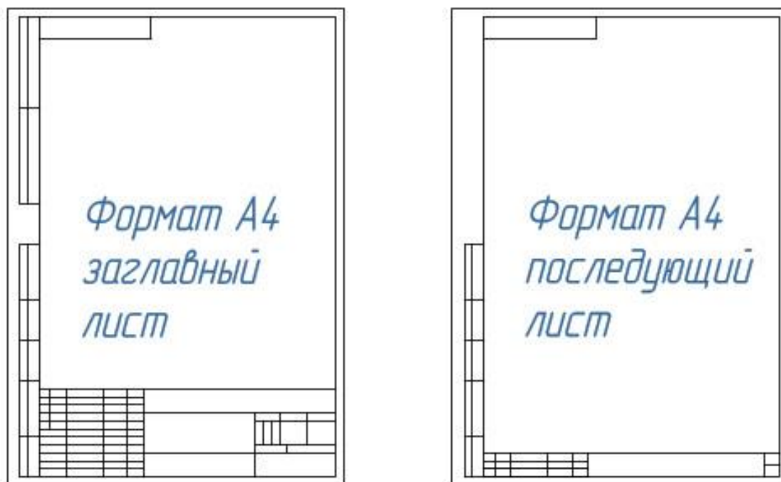
Рисунок 1 – размещение основной надписи на листе А4 дипломной работы
