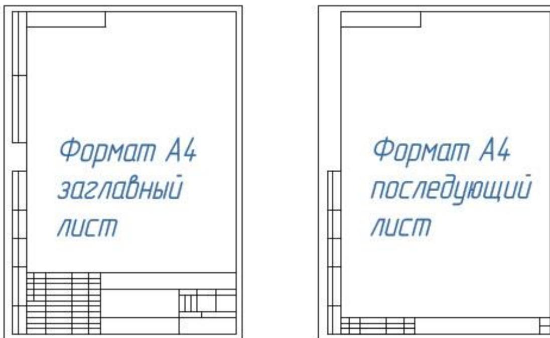
Рисунок 1 – размещение основной надписи на листе А4 пояснительной записки дипломного проекта
