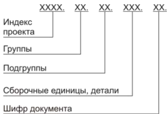
Рисунок 3.1 – Структура обозначения технической документации
