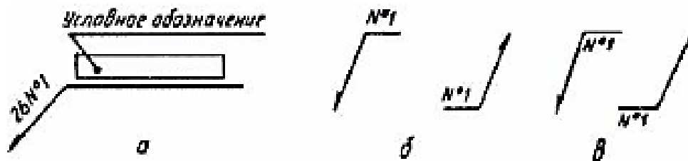
Рисунок 3.18 Условное обозначение одинаковых швов на чертеже
