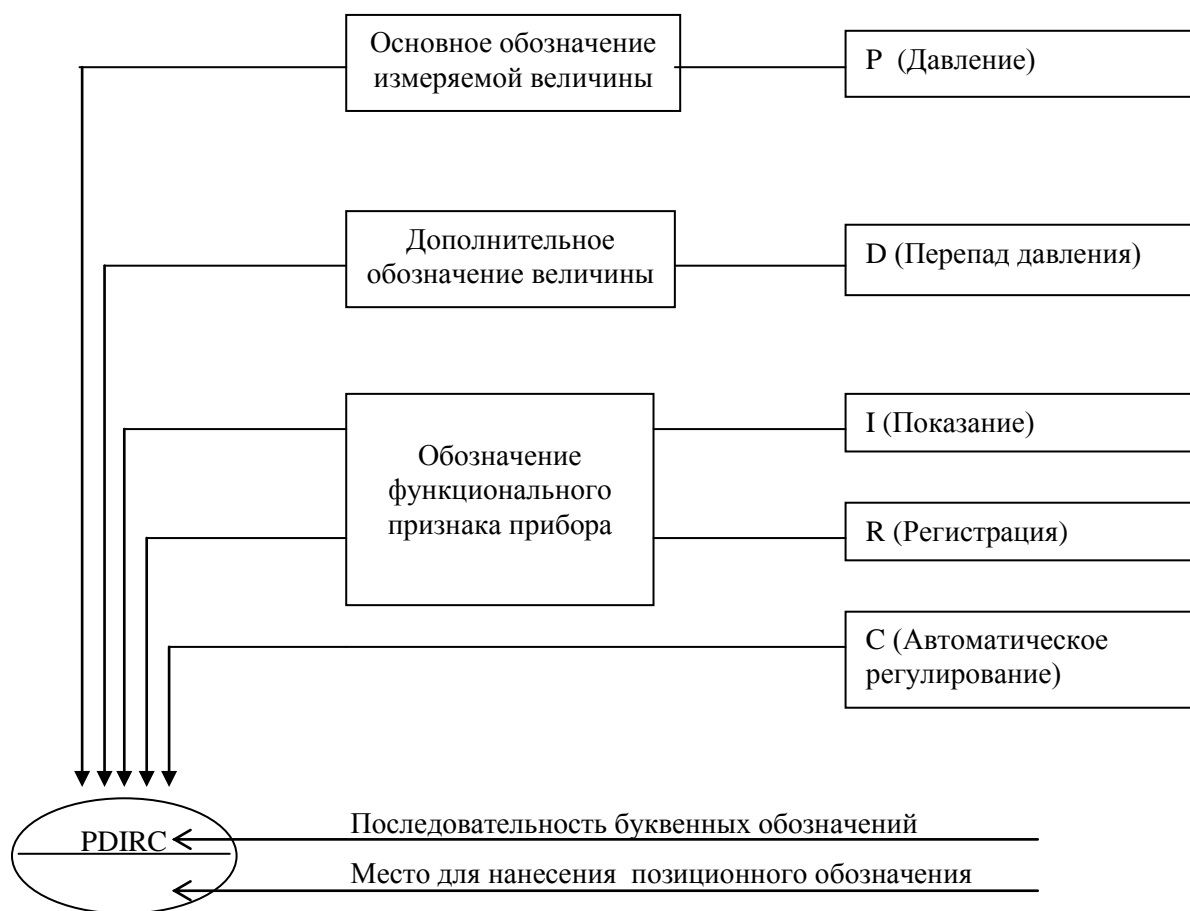
Рисунок 4.1 - Пример построения условного обозначения прибора
