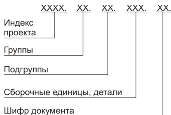
Рисунок 3.1 – Структура обозначения технической документации
