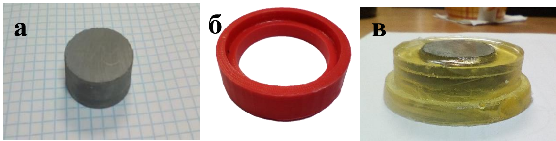
Рисунок 2.9 – Внешний вид глинистого образца (а), пластиковой формы (б) и готовой основы с глинистым образцом, залитым эпоксидной смолой (в)
