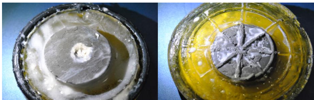
Рисунок Г.9 – Внешний вид глинистого образца после воздействия жидкости из водного раствора силиката натрия в растворе карбоксиметилцеллюлозы и биополимерного пресного раствора (вид сверху и снизу соответственно)
