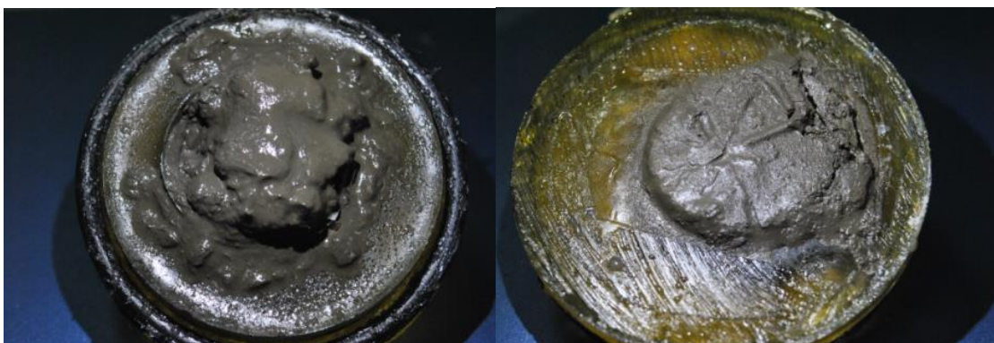
Рисунок Г.2 – Внешний вид глинистого образца после разрушения водным раствором хлористого натрия (вид сверху и снизу соответственно)
