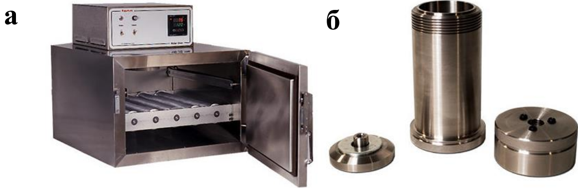
Рисунок 2.5 – Вальцовая печь (а) и ячейка (б), предназначенные для исследования технологической жидкости путем термостатирования кернового материала в динамических условиях
