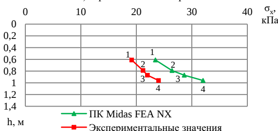
Рисунок 11. Результаты сопоставления экспериментальных данных с результатами аналитического расчета НС в точках грунтового массива на НВГММГ на конечный период мониторинга
