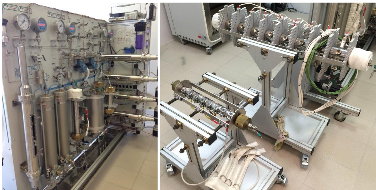
Рисунок 4.3 – Общий вид установки для высокотемпературных исследований керна «ПИК-ОФП/ЭП-К-Т»
