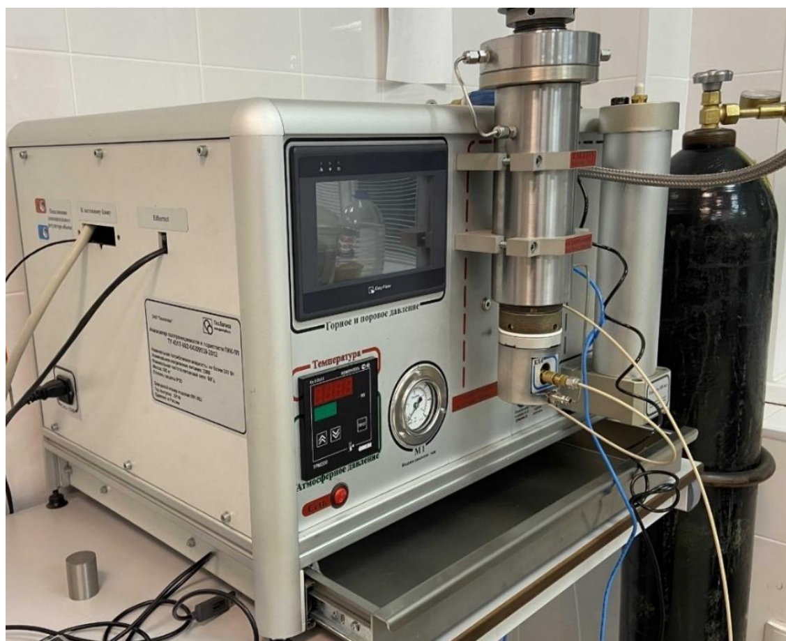
Рисунок 4.2 – Анализатор газопроницаемости и пористости сухих цилиндрических образцов керна «ПИК-ПП»
