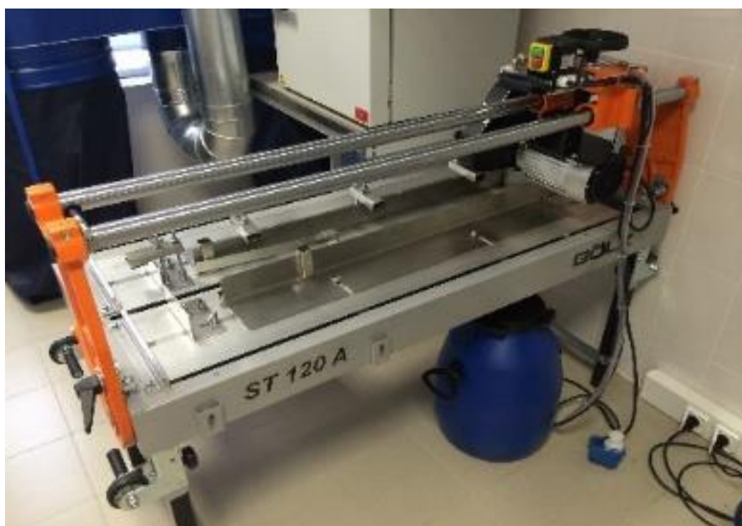
Рисунок 4.1 – Станок для продольной и поперечной резки керновых образцов
