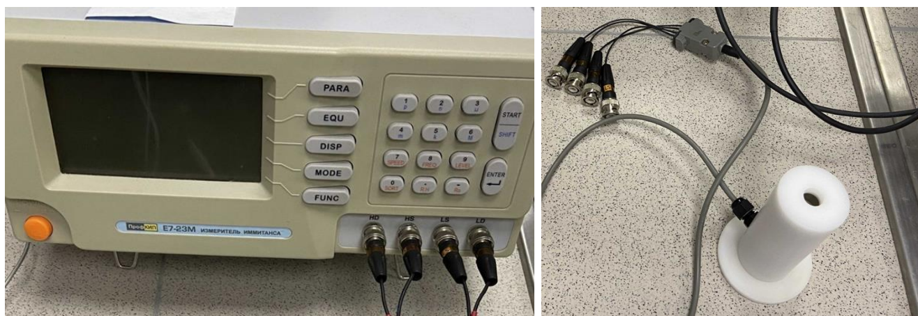
Рисунок 4.5 – Общий вид прибора «ПетроОм» (измеритель иммитанса) с кюветой для определения электрического сопротивления жидкости
