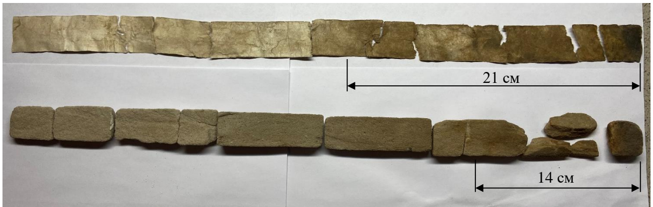
Рисунок 4.30 – Фильтровальная бумага и полуцилиндрические образцы керна после проведения эксперимента на насыпной модели № 1
