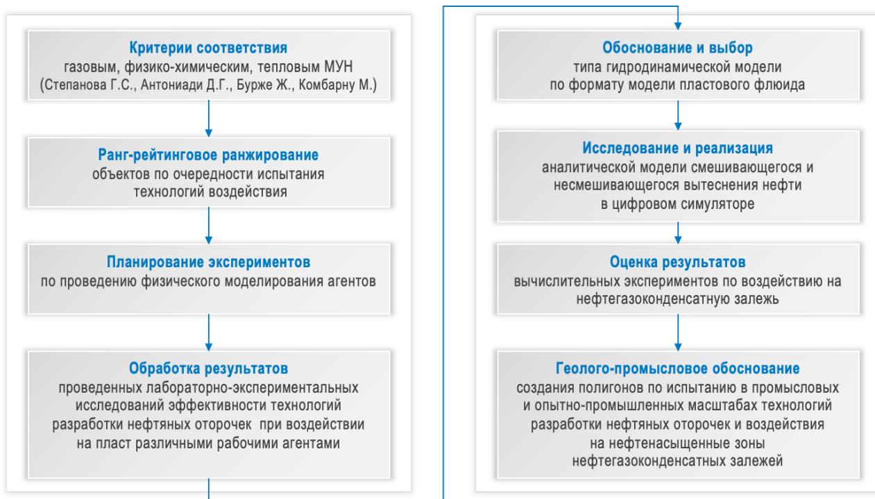
Рисунок 2 – Алгоритм исследования и применения газовых агентов воздействия
