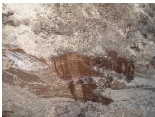
Рисунок 3. Фильтрация воды через слой уплотненного торфа на границе «ЗП-основание» (февраль-март 2013г.)
