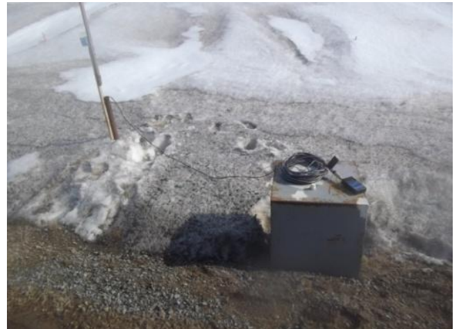
Рисунок 6. Замер температуры в термоскважине
