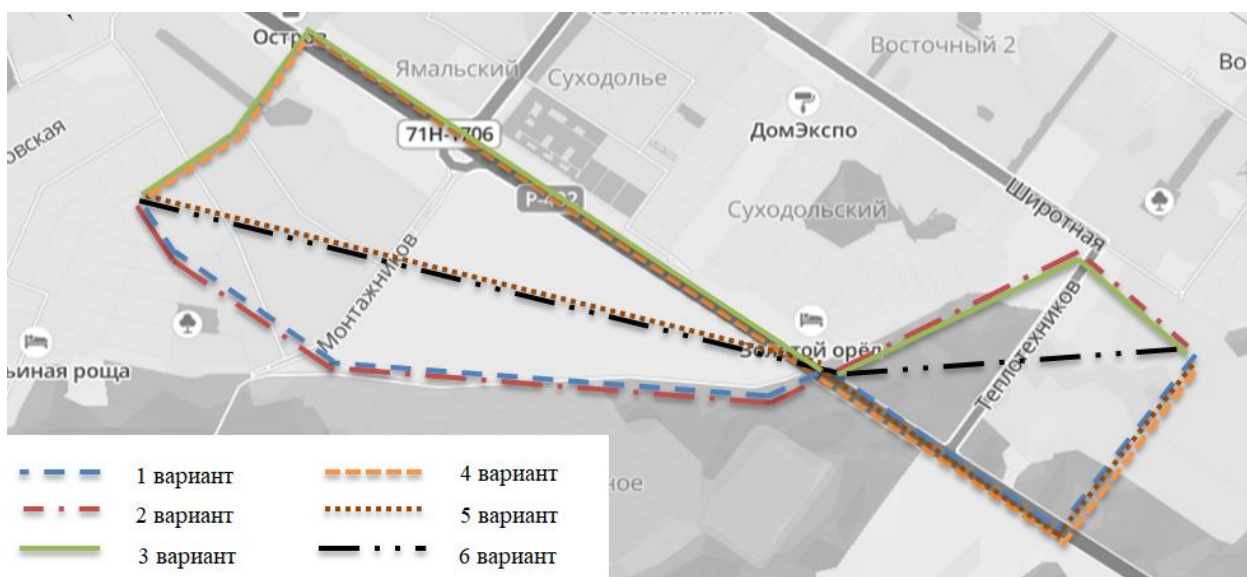
Рисунок 9 – Ситуационная карта расположения 12 планировочного района г. Тюмень с указанием вариантов трасс тепловых сетей
