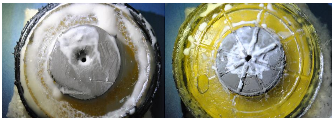
Рисунок Г.5 – Внешний вид глинистого образца после разрушения в биополимерном пресном растворе (вид сверху и снизу соответственно)
