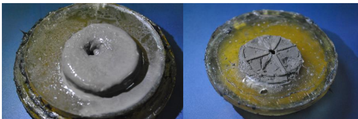
Рисунок Г.3 – Внешний вид глинистого образца после разрушения пресной водой (вид сверху и снизу соответственно)
