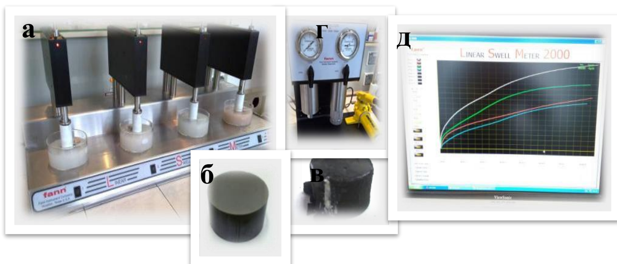
Рисунок 2.4 – Прибор для исследования линейного увеличения высоты глинистых образцов (а), глинистые образцы (б, в), компактор для их получения (г), график увеличения высоты глинистых образцов в зависимости от времени (д)
