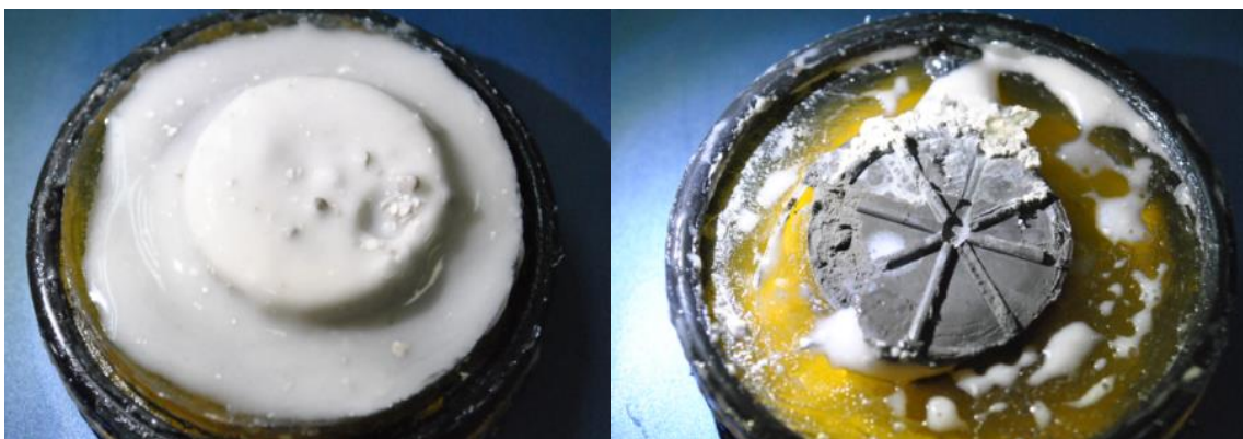
Рисунок Г.4 – Внешний вид глинистого образца после разрушения в биополимерном хлоркалийевом растворе
