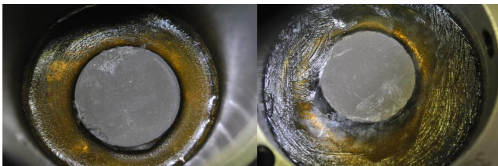
Рисунок Г.1 – Внешний вид глинистого образца, залитого эпоксидной смолой в ячейке модернизированного фильтр-пресса НТНР (вид сверху и снизу соответственно)
