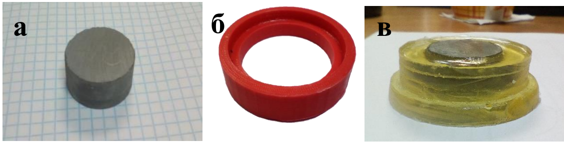
Рисунок 2.9 – Внешний вид глинистого образца (а), пластиковой формы (б) и готовой основы с глинистым образцом, залитым эпоксидной смолой (в)
