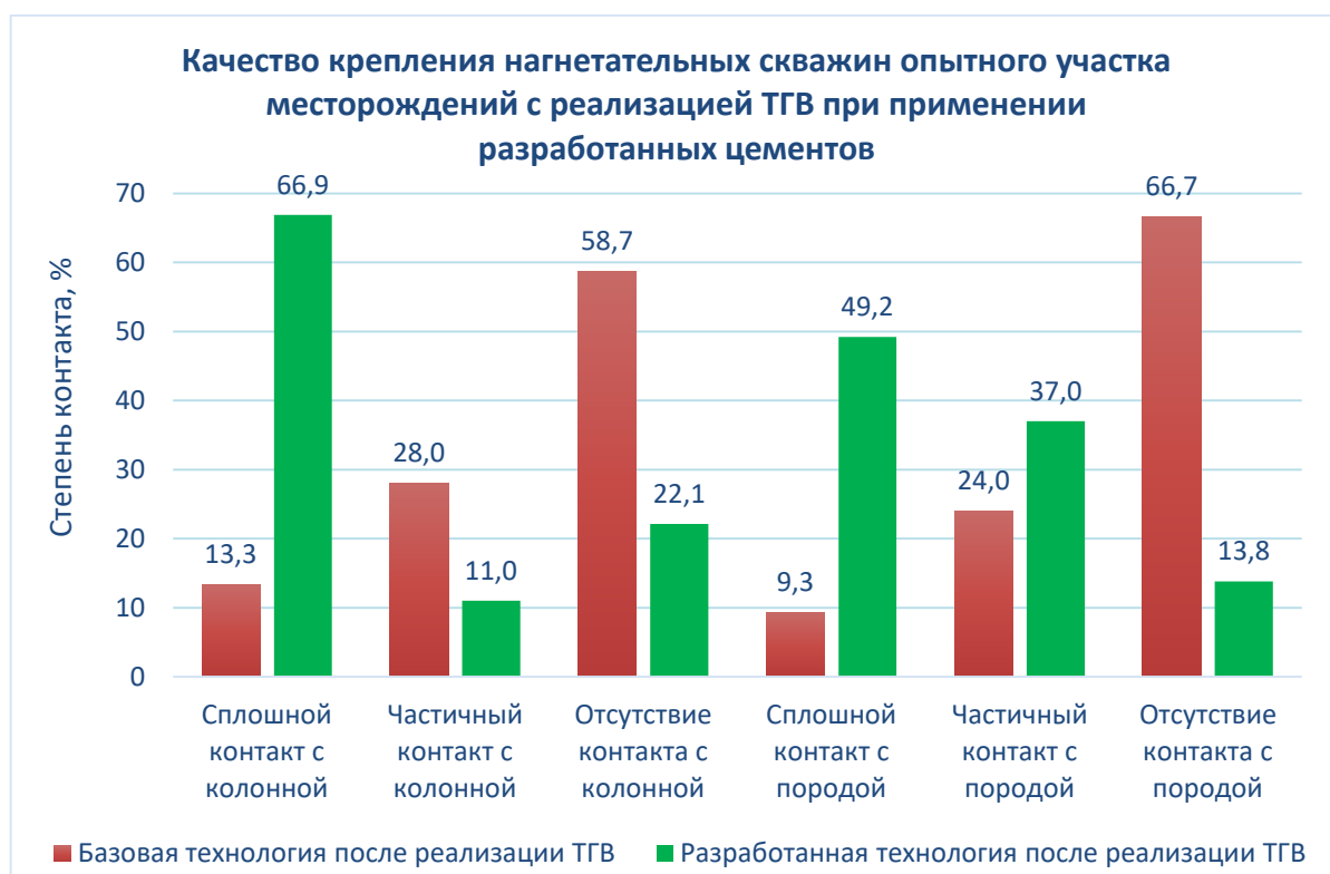
Рисунок 45 – Сведения о качестве крепления нагнетательных скважин опытного участка месторождений с реализацией ТГВ при применении разработанных цементов
