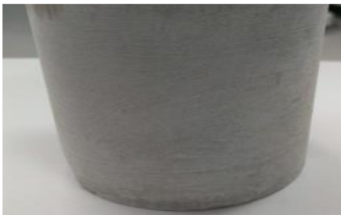
Рисунок 33 – Образец цементного камня на основе TermoLight-9 после термического воздействия
