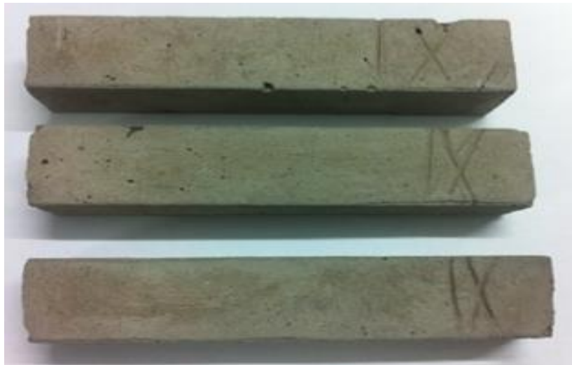
Рисунок 28 – Фотографии образцов тампонажного камня TermoLight-9 после десятого цикла воздействия температуры 300 °С
