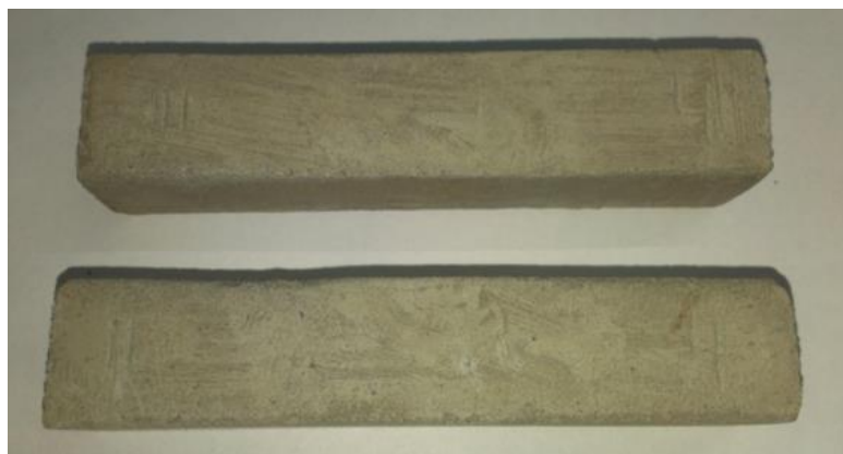
Рисунок 27 – Фотографии образцов тампонажного камня TermoLight-4 после десятого цикла воздействия температуры 160 °С
