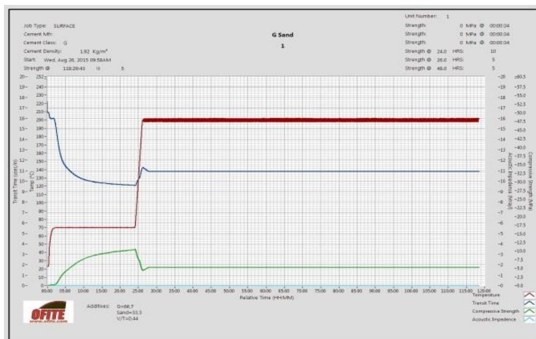
Рисунок 31 – График процесса набора прочности тампонажного цемента ПЦТ I-G с песком
