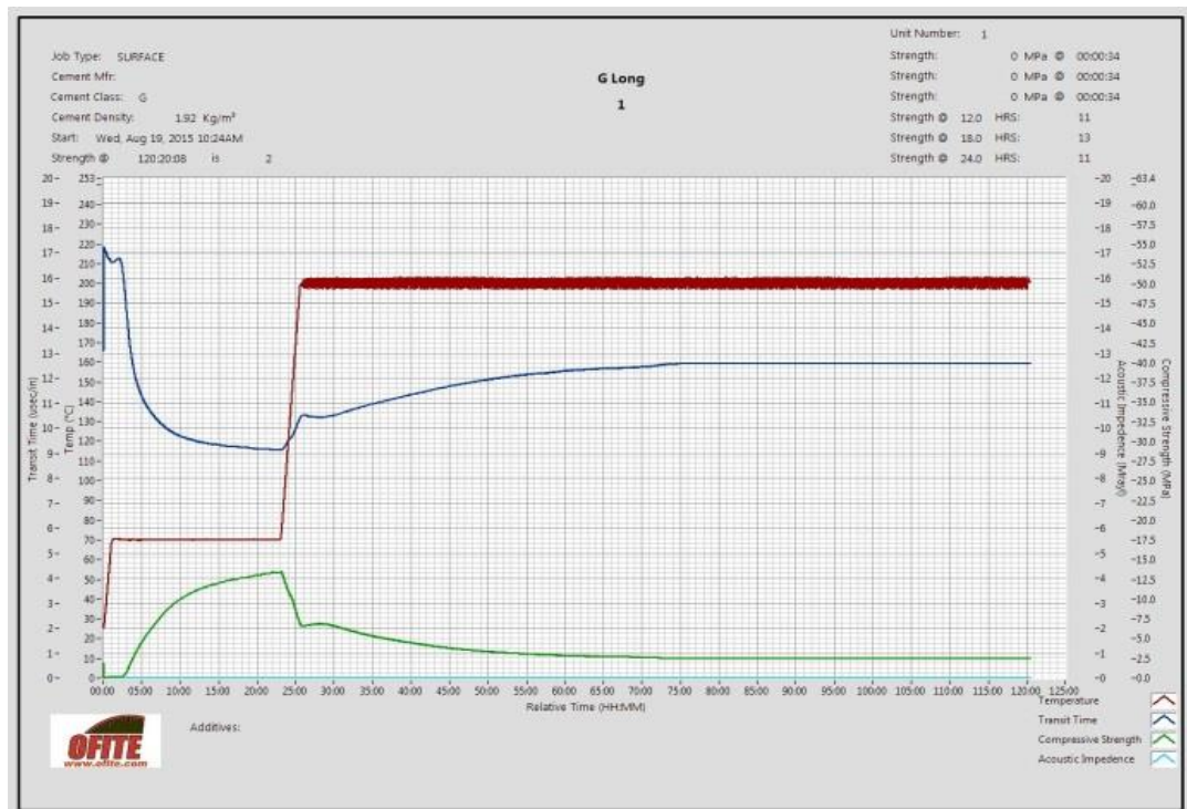
Рисунок 29 – График процесса набора прочности тампонажного цемента на основе чистого цемента ПЦТ I-G
