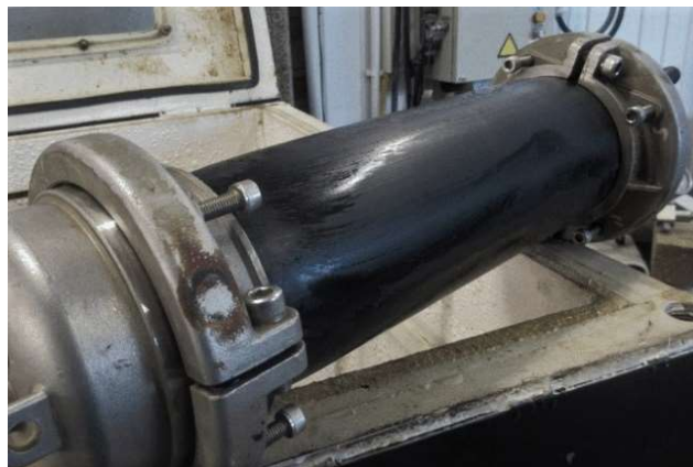
Рисунок 4 – Образец-катушка МПАТ с концевыми заглушками
