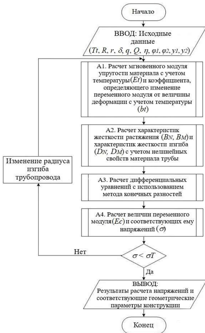
Рисунок 9 – Алгоритм для математической модели изгиба криволинейного стержня
